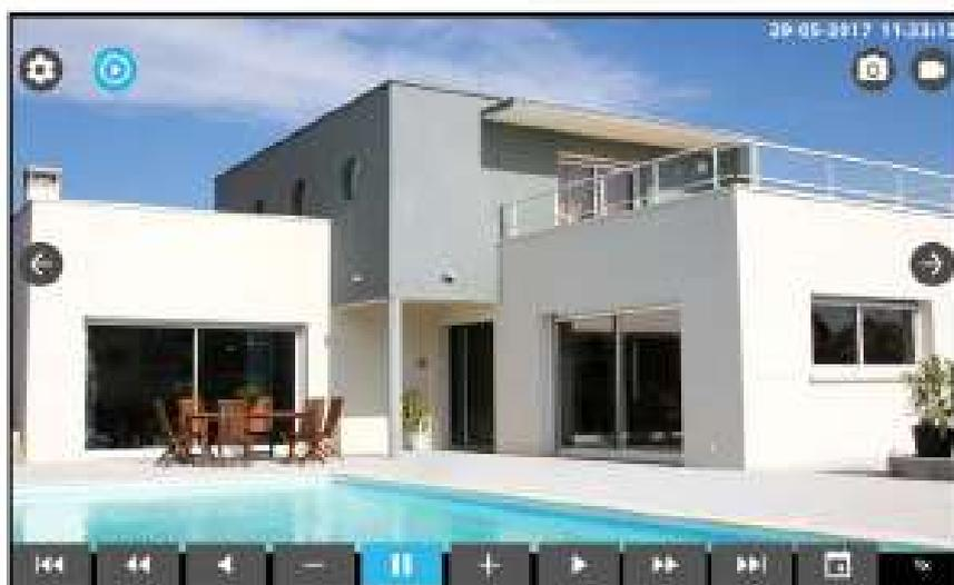
L'App Dallmeier Mobile Video Center 2 permette di accedere ai sistemi Dallmeier (DVR, NVR, server, telecamere) utilizzando un smartphone o tablet con sistema Android o iOS. È possibile accedere direttamente al live video così come alle immagini registrate anche quando si è in movimento. Una speciale transcodifica prepara il video per una visualizzazione ideale sul dispositivo mobile ed al contempo ne garantisce un elevato frame rate.
