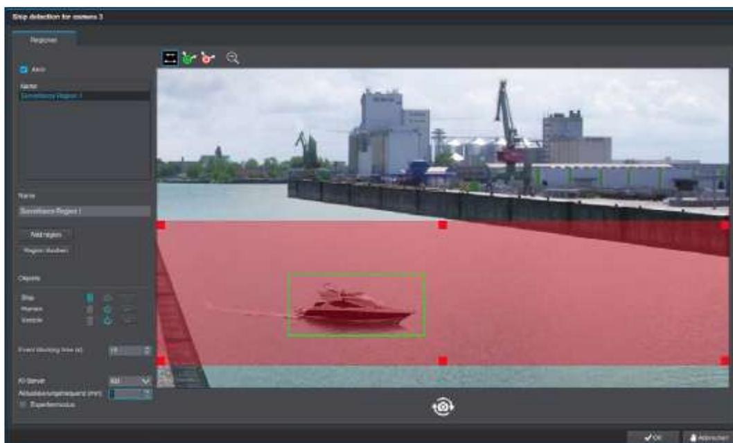
Il software SEDOR® AI Ship Detection rileva in modo affidabile grandi navi e piccole imbarcazioni in acque libere, basandosi su un sistema AI evoluto per classificazione di oggetti attraverso utilizzo di rete neurale appositamente addestrata. Il software analizza l'area di monitoraggio definita in un ciclo regolabile e immediatamente emette un messaggio corrispondente se una nave entra in quest'area.
