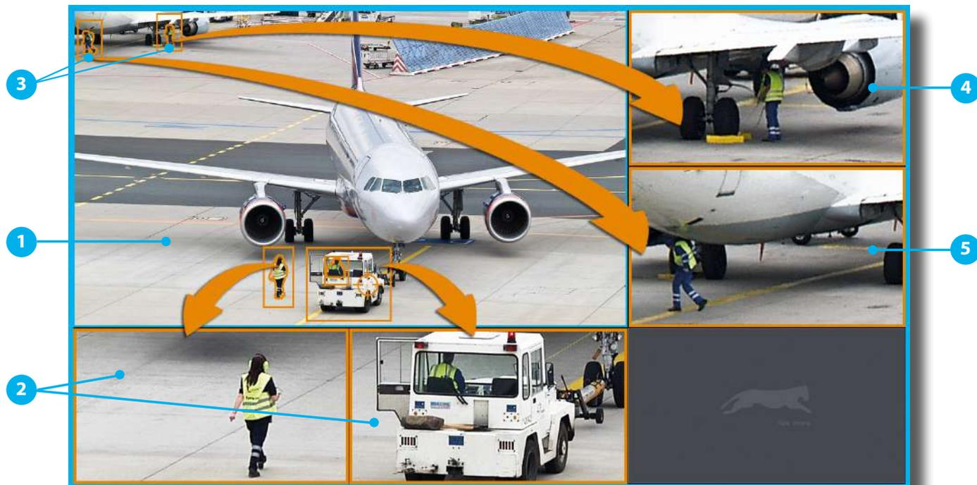
SeMSy® Compact AutoTracking utilizza i dati VCA delle telecamere di rete Dallmeier e dei sistemi Panomera®. Durante la visualizzazione del flusso video (live e riproduzione), i dati di analisi consentono il rilevamento di aree dell'immagine con persone o oggetti in movimento. Queste aree vengono visualizzate e ingrandite in modo ottimale in una suddivisione dei dettagli e garantiscono un attento controllo mirato durante la valutazione.
