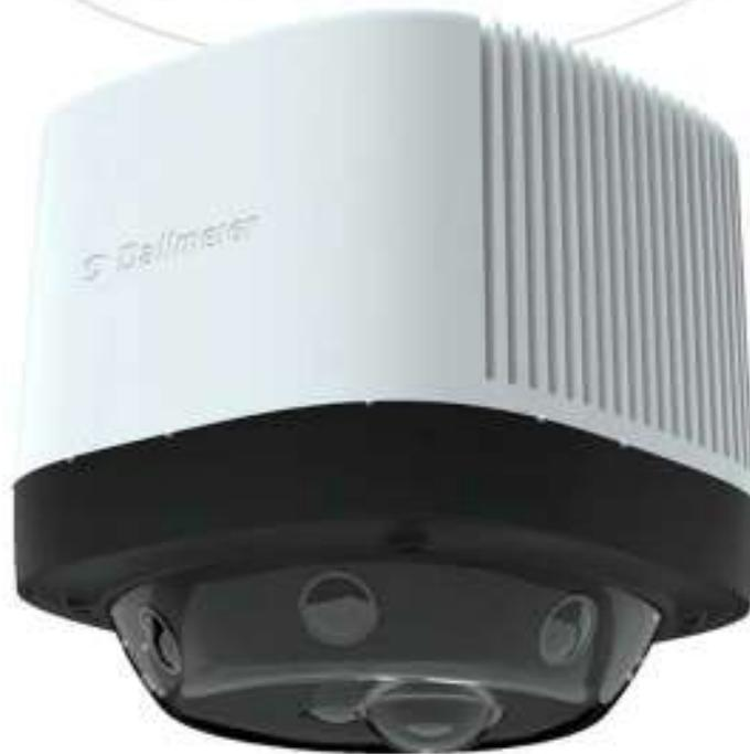
Sistema di sensori multi focale, 95 MPe, 30 fps, H.264, H.265, giorno/notte, UWDR, AI/VCA opzionale, campo di vista orizzontale 180°/360° e verticale 90°, risoluzione 125 px/m fino a 17 m, custodia dome
