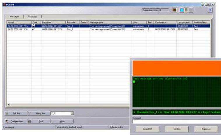
PGuard advance è un software centralizzato di analisi e management per messaggi (stato, evento, errore) di uno o più registratori, decoder, streamer e MicroStreamer di Dallmeier. Con PGuard advance è possibile selezionare, tra i molti tipi di messaggi diversi, solo determinati tipi di messaggio che saranno visualizzati in una finestra e segnalati acusticamente. Si possono anche selezionare i criteri di filtro, come per es. il periodo di tempo o i registratori che devono essere visualizzati.
