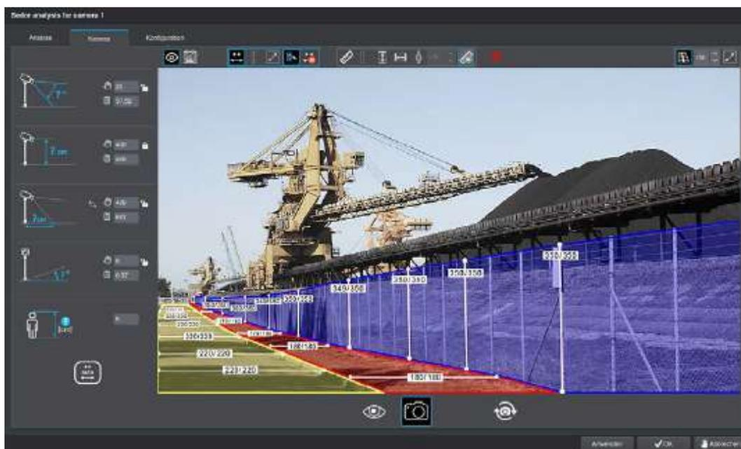
Il software SEDOR® AI Intruder Detection consente la protezione di aree liberamente definibili all'interno e all'esterno da accessi non autorizzati. Il software di analisi rileva oggetti che si avvicinano ad un'area definita e ne valuta la direzione di movimento e il tempo di sosta. Gli eventi rilevati vengono inseriti in un potente sistema di classificazione degli oggetti basato su reti neurali e infine avverte con un messaggio corrispondente.
